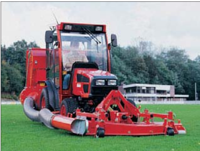
Perfekt ausgerüstet für die Grundstückspflege: Hakotrac 2600/3000 mit Front-Rotationsmäher, Arbeitsbreite 150 cm und leistungsfähiger Grasabsaugung. Für Wartungs- und Pflegeaufgaben läßt sich der Mäher manuell leicht hochklappen.
